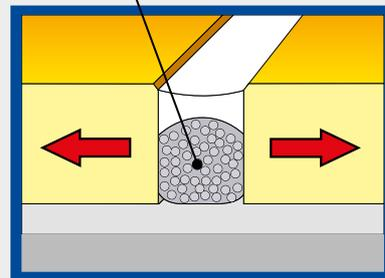
Nel caso di giunti molto profondi, per avere il giusto dimensionamento, fare ricorso a materiali di riempimento antiadesivi o a bassa coesione, quali polietilene espanso: **Saratoga JOINT•FILLER**.
