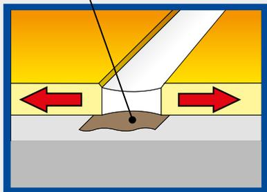
Nel caso di giunzioni poco profonde, utilizzare nastri in materiale antiadesivo (ad es. polietilene) per permettere una libera dilatazione.
