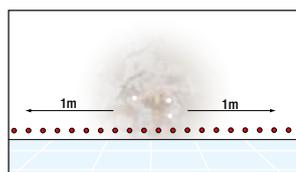
Nel caso di trattamento parziale di una parete o di una zona limitata, ampliare l'applicazione di 1 m a sinistra e a destra della parte da trattare, in modo da creare una barriera estesa e uniforme all'umidità di risalita.
