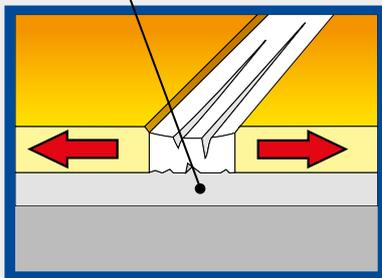
Evitare l'adesione ad una terza parete rigida, con conseguente rottura del giunto.
